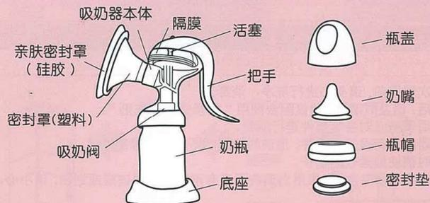
● 硅胶亲肤密封罩和塑料密封罩均配有 2 种尺寸。标准尺寸和加大尺寸。
