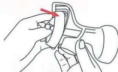
⑥按压把手的前端“PUSH”部分, 将把手顶部的孔卡入活塞的第一档(上)凹槽处。
