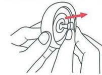
③拆分塑料密封罩和硅胶亲肤密封罩。
