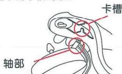
⑦将硅胶亲肤密封罩安装到塑料密封罩上。将组装好的密封罩安装在吸奶器本体上。
